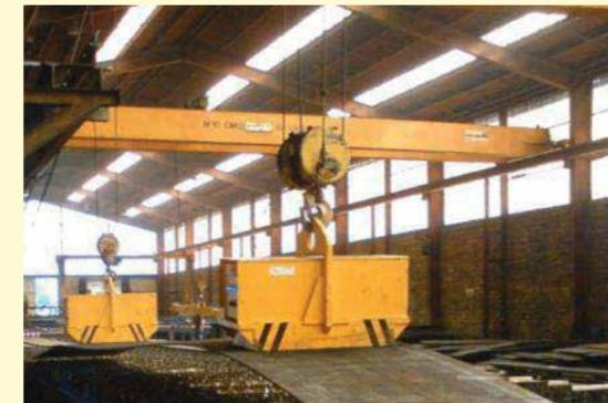
*Electro-aimants autonomes avec batteries et commande embarquées*
