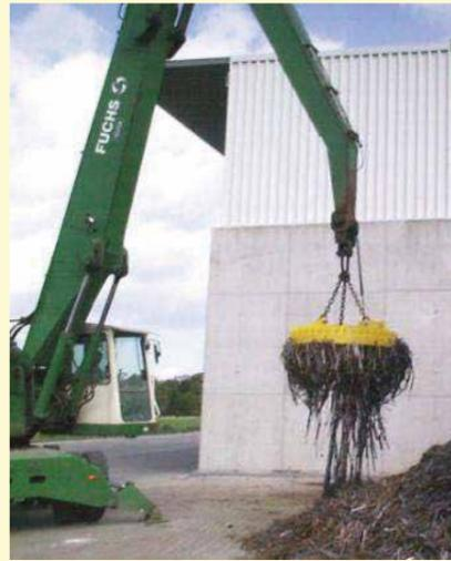
*Electro-aimants installés sur pelles hydrauliques*
