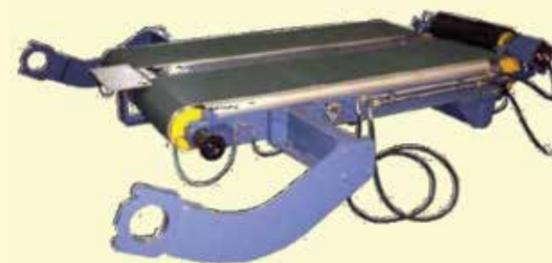
*Convoyeurs magnétiques pour déroulage de bobines*
