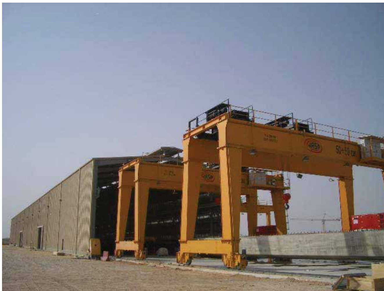
Grues avec accessoires spéciales pour la manipulation de voussoirs
