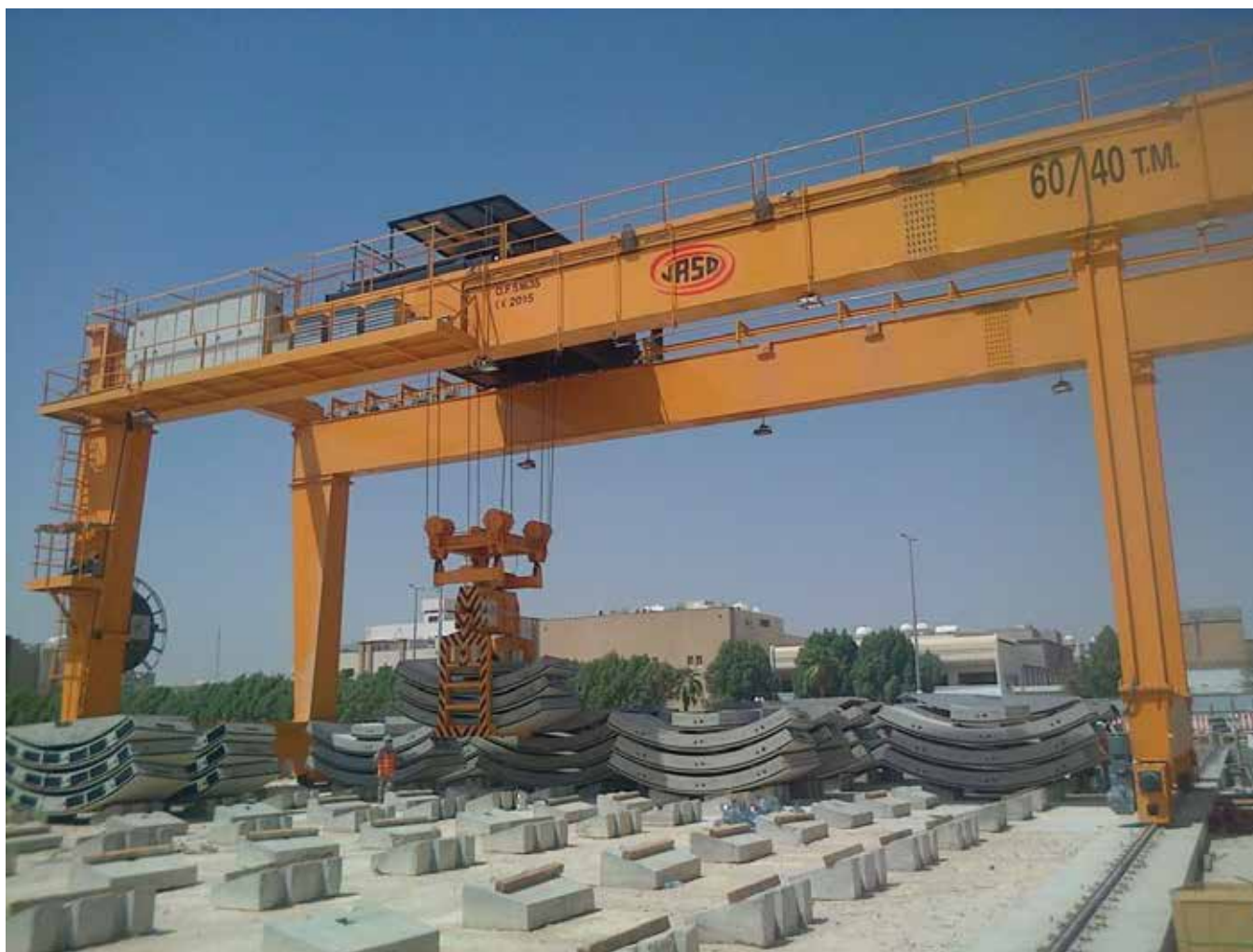
Grues avec accessoires spéciales pour la manipulation de préfabriqués de béton
